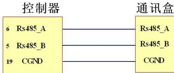
● Rs485 通讯的通讯线不要和高压线或大电流功率线走一起，接线的注意事项参考下面 4.9 通讯线缆接线方式。
